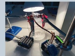
Montage électronique pour mesurer le niveau d'eau.
